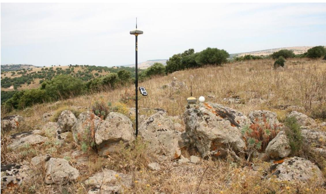
Fig. 5: Rilievo con GPS del circolo e dei target sferici di riferimento da utilizzare per la georeferenziazione delle scansioni (foto: P. Marcialis).
