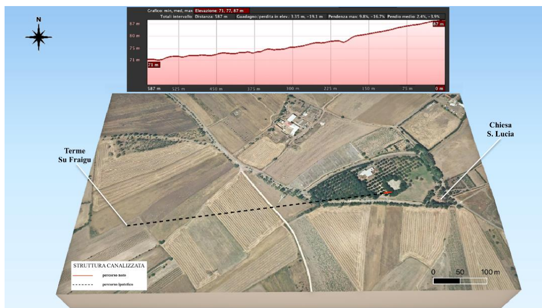
Fig. 12: MONASTIR - Loc. Santa Lucia. Profilo di elevazione e modello 3D del percorso ipotetico originario dell'acquedotto (elaborazione grafica D. Cinus).
