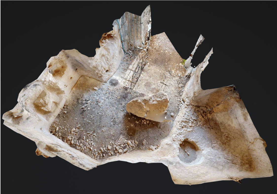
Fig. 18. Modello tridimensionale della chiesa di San Nocolicchio. visualizzazione "Dollhouse" generata da rilievo tramite camera LiDAR Matterport Pro3 (elaborazione a cura di S. P. Barbagallo, F. Stanco).
